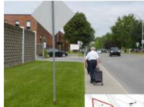
Figure 3: Le trottoir de moins de 1,7 m sur le boulevard Jules Poitras ne permet pas aux deux personnes âgées de circuler côte à côte.
