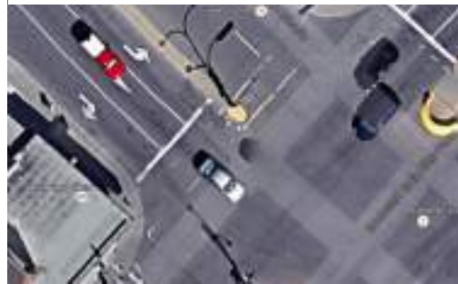
Figure 8 : La traverse nord de l'intersection Côte-Vertu/Décarie est marquée par un refuge surélevé au milieu des deux bandes parallèles forçant les piétons à le dévier. (Source de l'image : GoogleSatellite)
